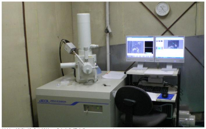
材料の観察・組成分析等に威力を発揮するSEM/EDS(JSM-6390、Dry-EDX 付き)
